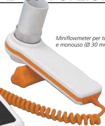
Miniflowmeter per turbina riutilizzabile e monouso (Ø 30 mm)
