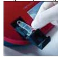
Inserire la microcuvette nel dispositivo
